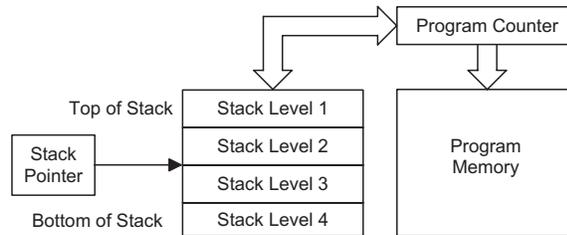
如果堆栈已满，且有非屏蔽的中断发生，则只有中断请求标志位会被置位，而中断响应会被禁止，直到堆栈指针发生递减（执行 RET 或 RETI 指令），中断才会被响应。这个特性提供程序设计者简单的方法来预防堆栈溢出。然而即使堆栈已满，CALL 指令仍然可以执行，从而造成堆栈溢出。使用时应避免堆栈溢出的情况发生，因为这样会造成不可预期的程序分支指令的执行错误。
