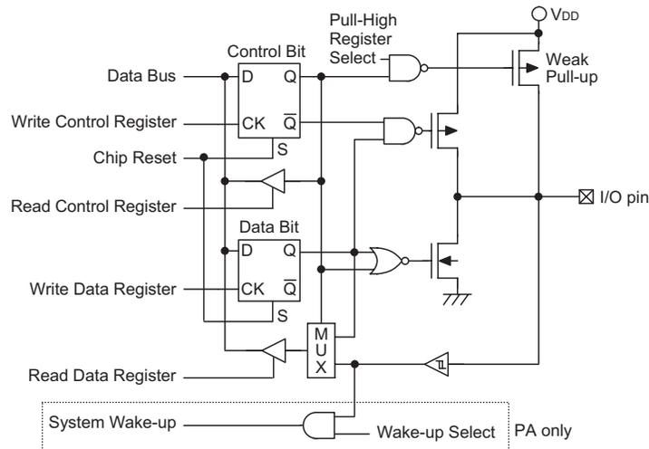
通用输入 / 输出端口结构
