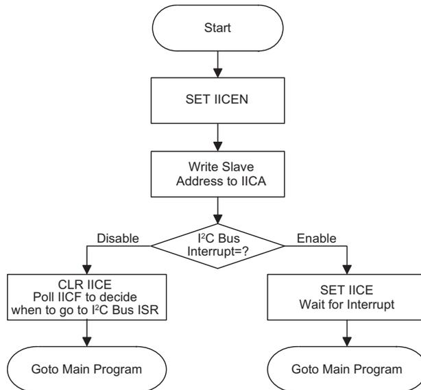
I<sup>2</sup>C 总线初始化流程图
